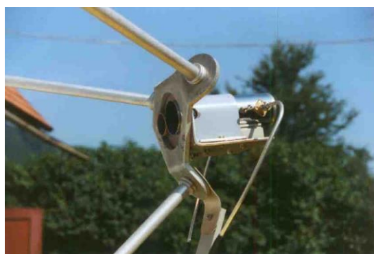
Fot. 2.1.10 i 2.1.11. Montaż promienników puszkowych w ognisku paraboli
