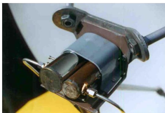
Fot. 2.1.10 i 2.1.11. Montaż promienników puszkowych w ognisku paraboli
